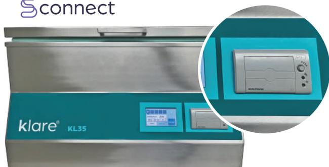
Possui impressora embutida e sistema inteligente de rastreabilidade exclusivo S.Connect®, que permite armazenar as informações dos ciclos realizados e ainda as informações do equipamento.
